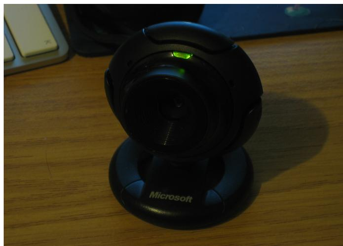
(Bild 5: Meine zur Infrarotkamera umgebaute Webcam)
