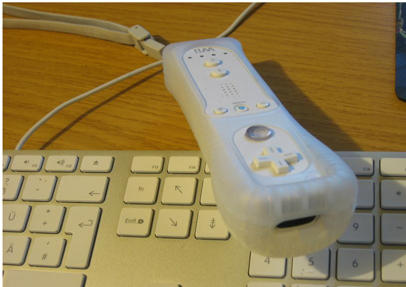
(Bild 9: Eine Wiimote mit eingebauter Infrarotkamera und Accelerometer)
